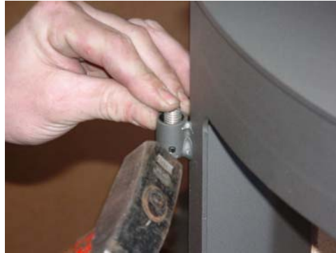
Schritt 3 Die Feder durch den Spannstiften befestigen
