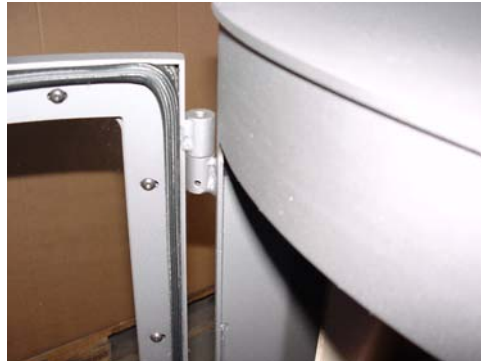
Schritt 1 Feuerraumtüre aushängen und Scharnierhülsen entfernen.
