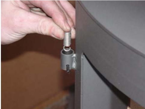
Schritt 2 Spannstifte ansetzen und Feder mit der Lasche nach unten einführen
